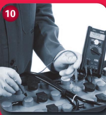
**Измерьте напряжение на элементах**
