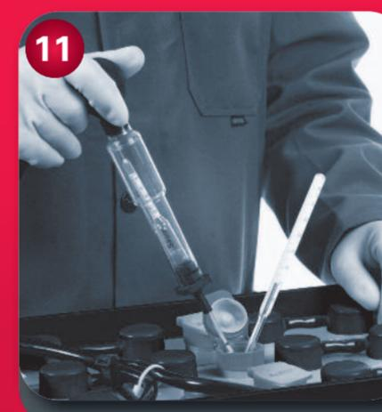
**Измерьте плотность и температуру электролита!**
